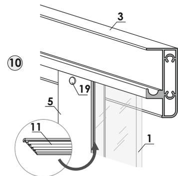
7. В пазы стоечных профилей установите водоотводной уплотнитель крылом внутрь (рис.7). Используйте киянку.
